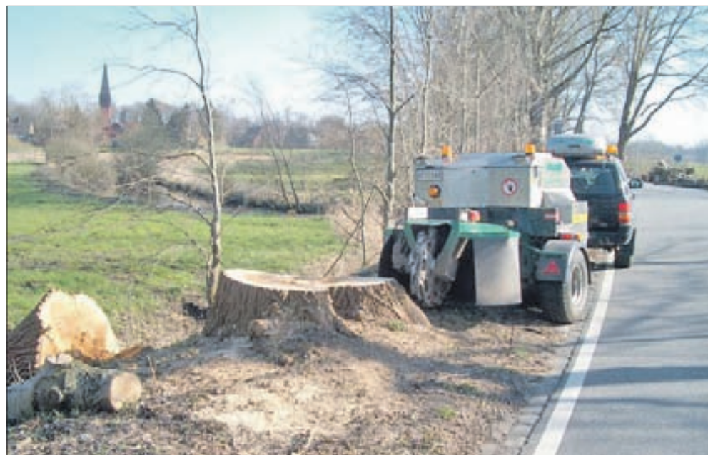
En af HasselHolms fræsere lægger an til at dybdefræse stubbe ved en landevej.
