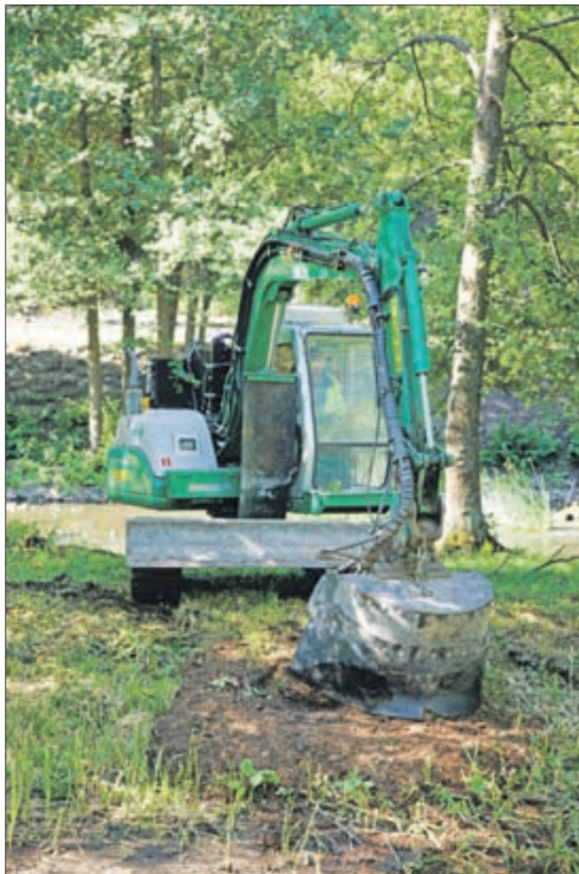
HasselHolms EcoGrinder S-111 fræser ned til omkring halvanden meter. Fræsehjulet på den otte tons tunge maskine roterer med 1000 omdrejninger i minuttet.
